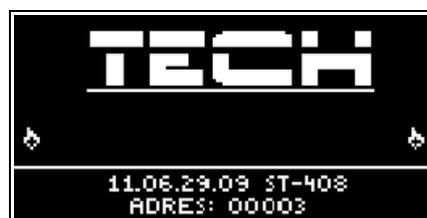
После включения этой опции на индикаторе появится логотип производителя котла и версия программного обеспечения регулятора.
