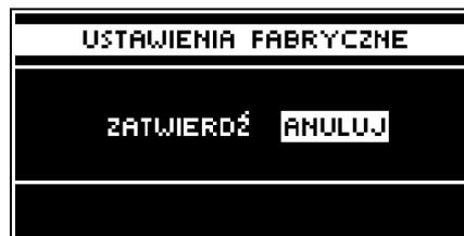
Регулятор предварительно настроен для работы. Однако, его следует привести в соответствие с собственными потребностями. В каждом моменте можно возвратиться к заводским настройкам. Включая функцию **заводские настройки**, теряются все настройки, установленные пользователем, а появляются настройки, записанные производителем. С этого момента можно заново установить собственные параметры.
