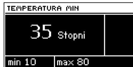
Эта функция позволяет настроить защиту котла от слишком холодной воды, возвращающейся из главной циркуляции, которая могла бы быть причиной низкотемпературной коррозии котла. Защита возврата действует таким образом, что когда температура слишком низкая, клапан прикрывается до времени, пока короткий цикл снова не достигнет соответствующей температуры. После включения этой функции пользователь настраивает минимально допустимую температуру возврата.
