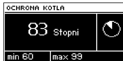
Защита от слишком высокой температуры возврата направлена на предотвращение опасного роста температуры котла. Пользователь настраивает максимально допустимую температуру возврата. В случае опасного роста температуры клапан начинает открываться на установке дома с целью охлаждения котла. Эта функция включена постоянно (возможность выключения единственно в сервисном меню).
