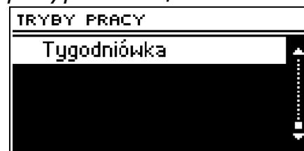
**НЕДЕЛЬНОЕ УПРАВЛЕНИЕ** - заданная температура клапана зависит от значения отклонений, определенных на отдельные дни недели в разделе *Недельное управление* (см. раздел: IV.с.16). В этом режиме не активно комнатное и напольное управление. Информация об активном недельном управлении пульсирует на главном экране в виде значения текущего отклонения температуры (на месте надписи „зад”).
