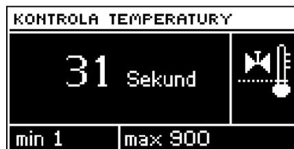
Этот параметр отвечает за частоту проверки (контроля) температуры воды за клапаном для системы Ц.О. или Г.В.С. Если датчик укажет изменение температуры (отклонение от заданной), то электроклапан приоткроется или прикроется на установленный шаг, чтобы достичь заданной температуры.
