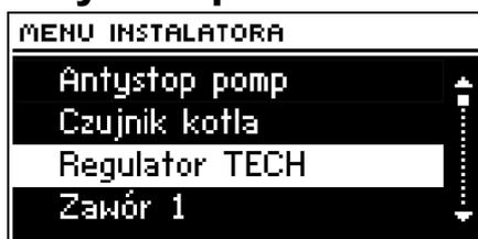
Эта опция позволяет включить/выключить активность комнатного регулятора TECH. Чтобы он работал совместно с соответствующим клапаном, следует дополнительно активировать этот тип комнатного регулятора и соответствующий режим работы в меню соответствующего клапана.
