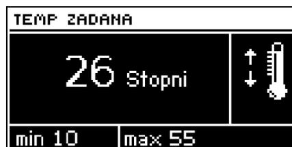
При помощи этой функции устанавливается требуемая температура, которую клапан 1 будет поддерживать. Эту температуру можно также изменить непосредственно из *главного экрана* контроллера, когда активный вид *Темп. 1*. Во время правильной работы температура воды за клапаном будет стремиться к заданной температуре клапана.
