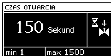
Параметр, определяющий время, которое необходимо, чтобы сервомотор клапана открыл клапан с положения 0% до 100%. Это время следует подобрать согласно установленному сервомотору клапана (указан на заводском щитке).
