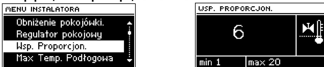
Коэффициент пропорциональности применяется для определения шага клапана. Чем ближе заданной температуры, тем шаг меньше. Если коэффициент будет высоким, клапан будет быстрее достигать открытия, приближенного к соответствующему, но будет оно мало точным. Процент отдельного открытия рассчитывается на основании формулы:
