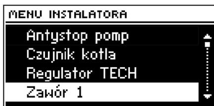
При помощи функции, содержащихся в этом подменю, производится изменение настроек различных параметров *клапана 1*, таким образом, чтобы он работал правильно и в соответствии с ожиданием пользователя.
