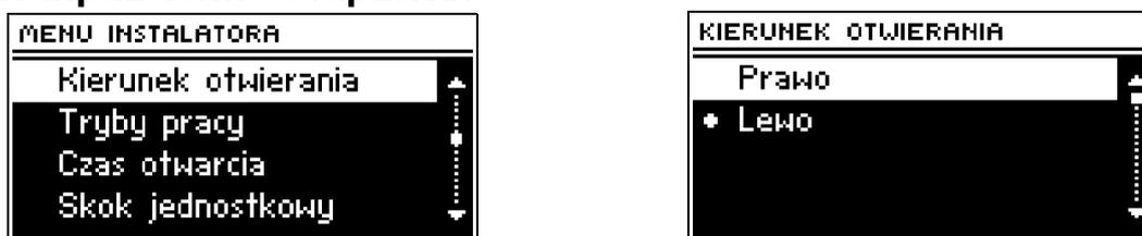
Если после подключения клапана к контроллеру окажется, что он должен был быть подключен наоборот, то не нужно его переключать, достаточно изменить в этом параметре направление открытия.
