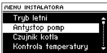
После включения этой функции насос клапана будет включаться каждые 10 дней на 2 минуты. Это предотвращает застаивание воды в установке по окончании отопительного сезона.
